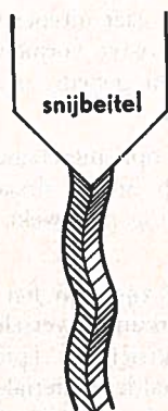
Fig. 3. De snijbeitel brengt een slingerende groef aan in de lakplaat.
